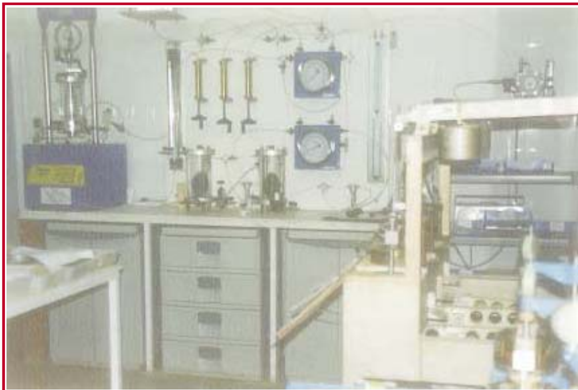
Aparato de ensayo Triaxial.
